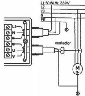
Diagrama de cableado para la conexión de bombas de motor trifásicas de 380 V mediante interruptor de control remoto.
