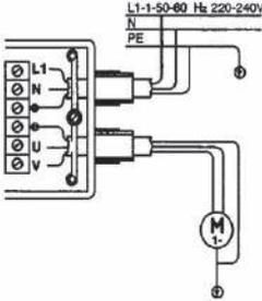
Diagrama de cableado para la conexión de bombas monofásicas de 110V hasta 1,1 KW.
