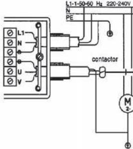
Diagrama de cableado para la conexión de bombas monofásicas de 110V sobre 1.1KW. mediante interruptor de control remoto.
