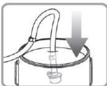
3. Sumerja la tubería de succión en agua o solvente de lavado.\*
