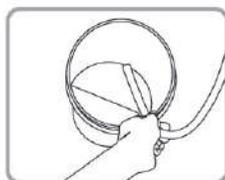
3. Introduzca la tubería de imprimación en un cubo de residuos.
