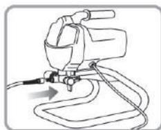
1. Conecte y ajuste la manguera a la salida.
