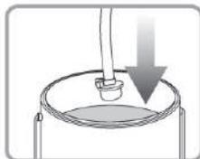
8. Introduzca la tubería de succión en la cubeta de pintura.
