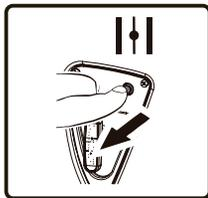
8. Mantenga presionado el interruptor del motor en la posición "START" (II) durante unos segundos y suelte el interruptor en la posición "RUN" (I).
