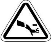
El retroceso del cable de arranque (retracción rápida) tirará de la mano y del brazo hacia el motor más rápido de lo que puede soltarse, lo que podría causar fracturas, hematomas o esguinces, resultando en lesiones graves.
